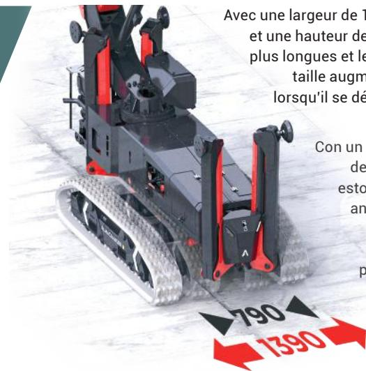
Avec une largeur de 1,39 m, une longueur de 2,15 m et une hauteur de 0,47 m, ces chenilles sont les plus longues et les plus larges du marché. Leur taille augmente la sécurité de l'opérateur lorsqu'il se déplace sur un terrain accidenté et en pente.
