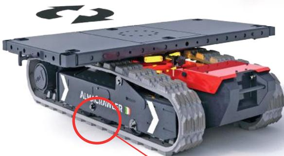
Die Plattform sitzt auf einem frei drehbaren Kugellager mit 15 Möglichkeiten der Arretierung und passt sich somit flexibel an Ihre Anforderungen an.
