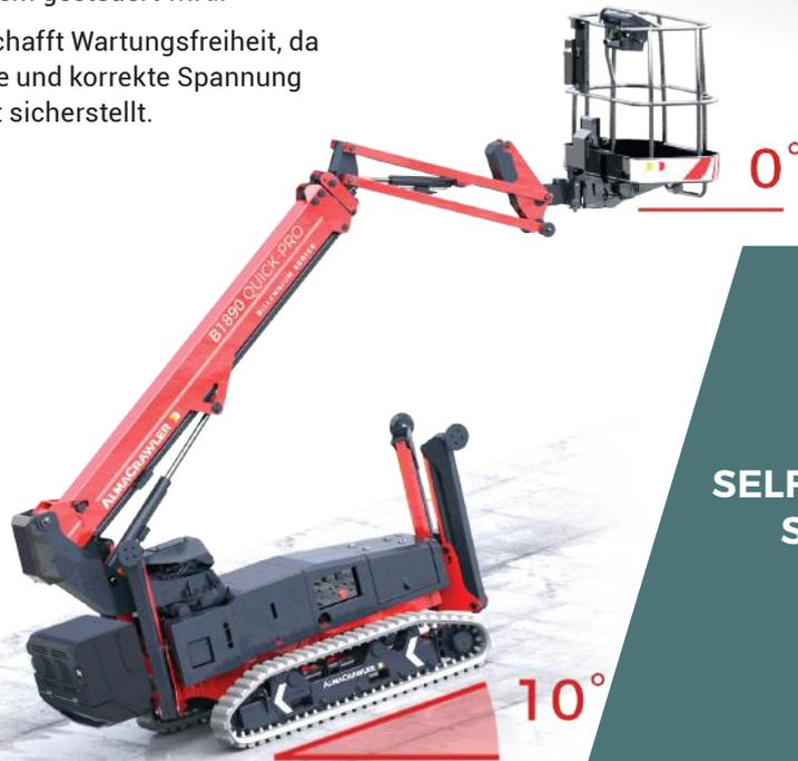
Das SPS-System ermöglicht den Einsatz der BillioniumSpiderbooms auch ohne das Absenken der Stützen, die Längsnivellierung bis maximal 10° bei einer maximalen Arbeitshöhe von 8 m für den B1570 und 9,40 m für den B1890 (max. Querneigung 5°).
