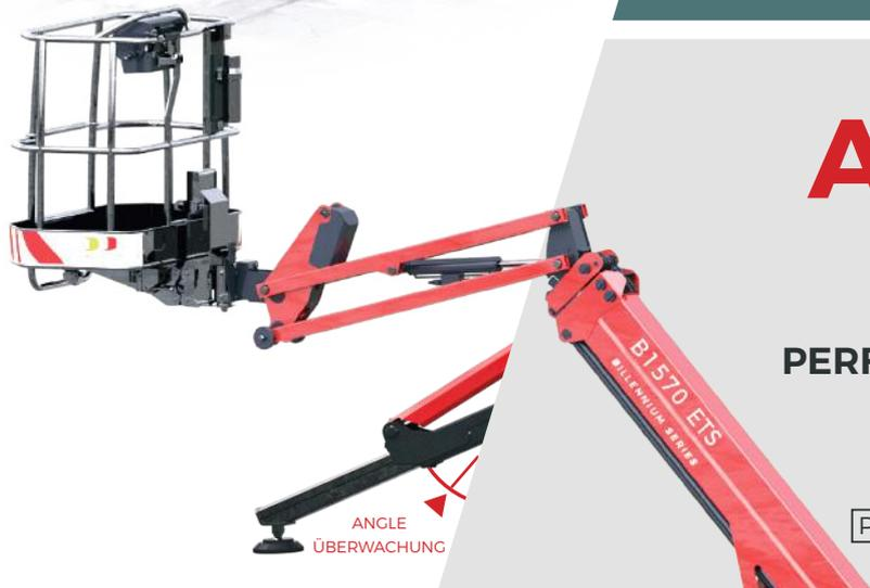
Dieses System berechnet den Stabilisierungsbereich in Echtzeit, indem es den Senkungswinkel jedes einzelnen Stabilisators misst, um die Arbeitsleistung über den gesamten Arbeitsbereich bis zu 0,5 m zusätzlich zu optimieren.
