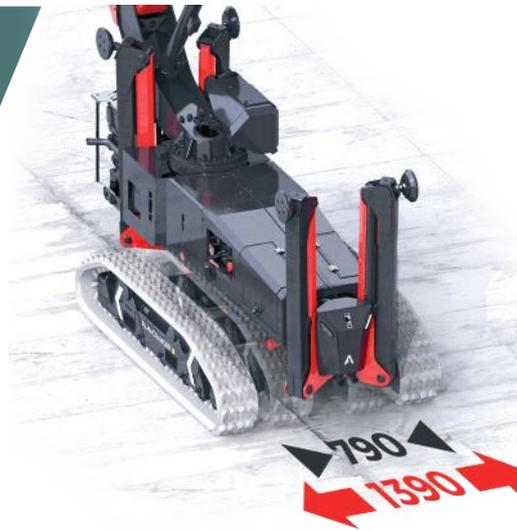
Mit einer Breite von 1,39 m, einer Länge von 2,17 m und einer Höhe von 0,47 m sind diese Ketten die längsten und breitesten auf dem Markt.
